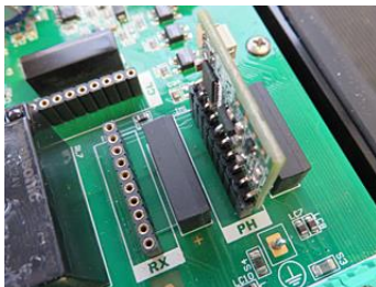
Ranura para el módulo de pH (PH)
